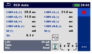
RCD Auto 20:45 t IAN x1, (+) 28.6 ms t IAN x1, (-) 21.0 ms t IΔN x2, (+) 11.9 ms t IΔN x2, (-) 16.9 ms t IΔN x5, (-) t IΔN x5, (+) ms t IΔN x0.5, (+) t IΔN x0.5, (-) ms ms ld (+) mA ld (-) mA 0.3 V Uc I dN
