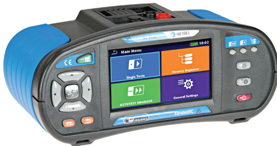
De innovatieve Metrel Eurotest XC brengt kleur en bedieningsgemak in de wereld van elektrische installatietesters. De Eurotest XC zet opnieuw de trend met een, voor installatietesters uniek, kleuren aanraakscherm en Bluetooth communicatie. Het instrument biedt daarmee een enorme vrijheid in de bediening. De bediening kan via het aanraakscherm maar ook via de solide drukknoppen of gedeeltelijk via het testhandvat.
