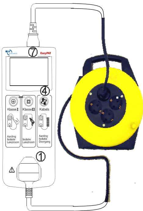
Figuur 11: Testen Verlengkabels / Haspels
